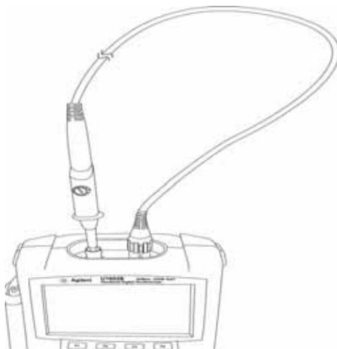
圖 1-10 示波器探頭補償的連接
