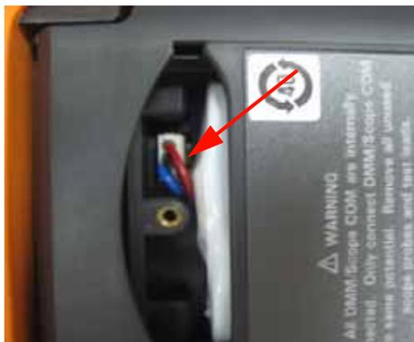
圖 8-6 使用鑷子拔出三線連接器。
