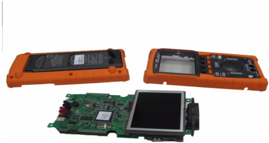
圖 8-10 移除儀器 PCBA 電路板的前外殼（右）與後外殼（左）
