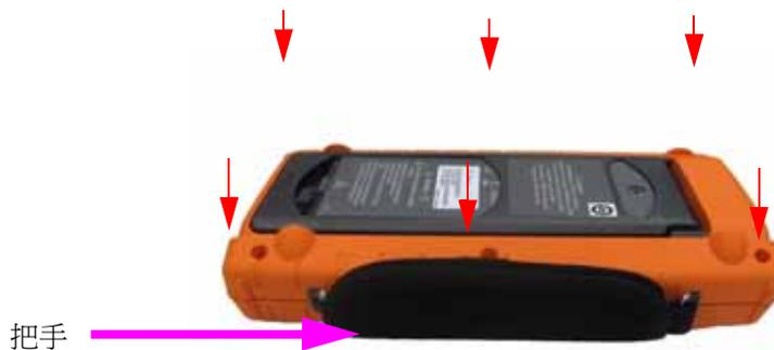
圖 8-7 移除後倉蓋上的螺絲
