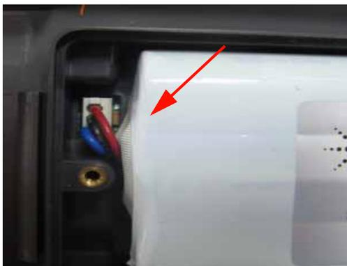
圖 8-4 使用鑷子將三線連接器從 PCBA 電路板上拔起
